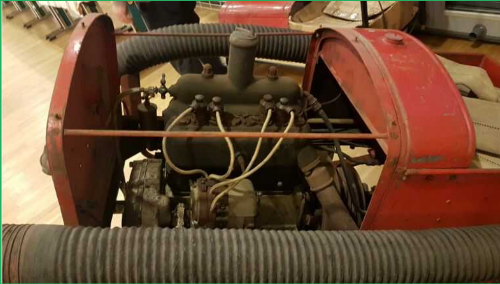
Gros plan sur la De Dion Bouton : motopompe remorquable
